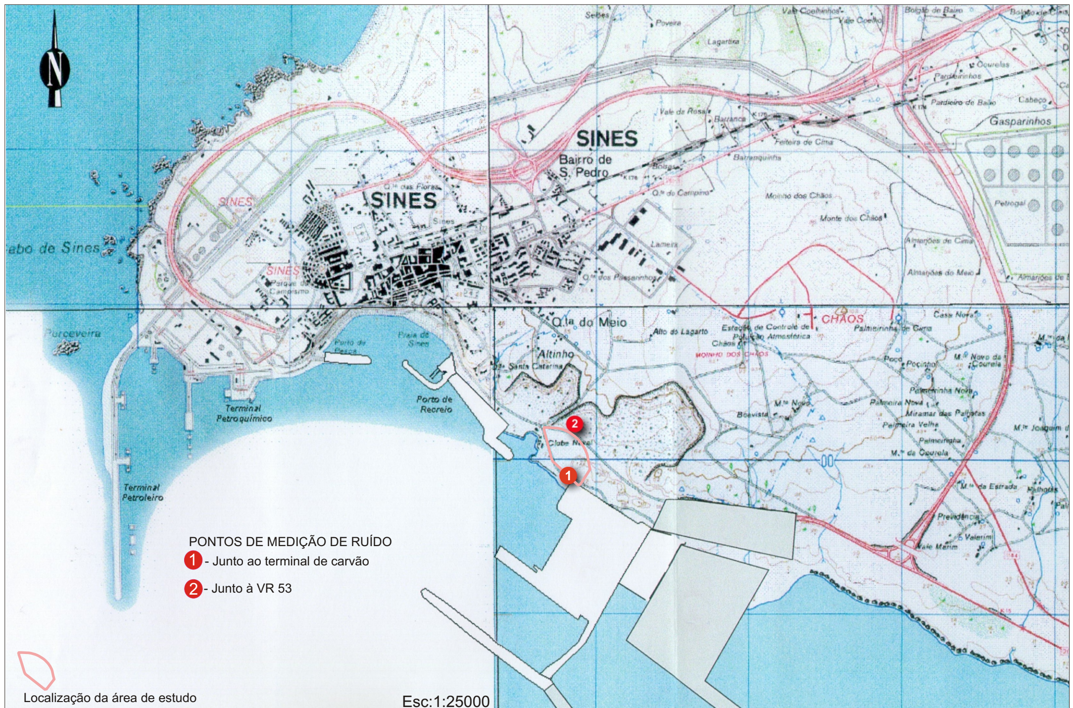
Figura 4.9 - Localização dos pontos de medição de ruído
